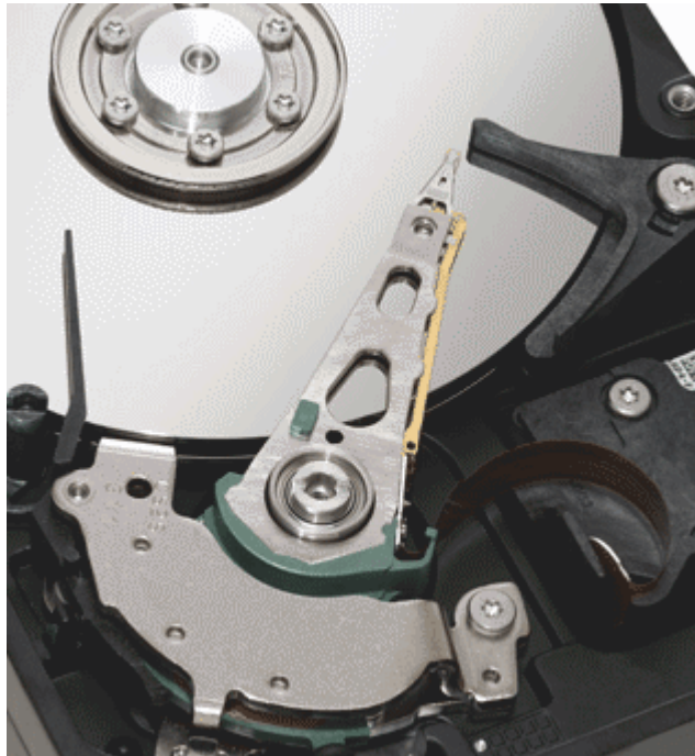
Hình 2.1: Đầu từ và các tấm ghi đĩa cứng.
